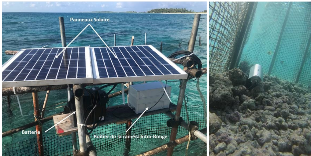
Figure 5 : Vue d'ensemble (à gauche) de la plate-forme installée à proximité du parc afin d'obtenir des images de nuit des requins tentant potentiellement de pénétrer dans le parc. A droite : vue sous-marine (globale) de la caméra Infra-rouge installée au ras du sol (afin d'éviter la prise au courant fort à cet endroit de la passe). Equipée d'un grand angle, elle devait capter tout requin se présentant dans un rayon de 2 m autour de l'entrée du parc.
